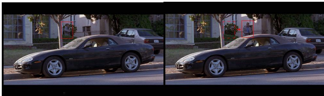
Na tomto záběru se mění pouze pozice člověka, nemusíme proto ukládat 2x celou scénerii
